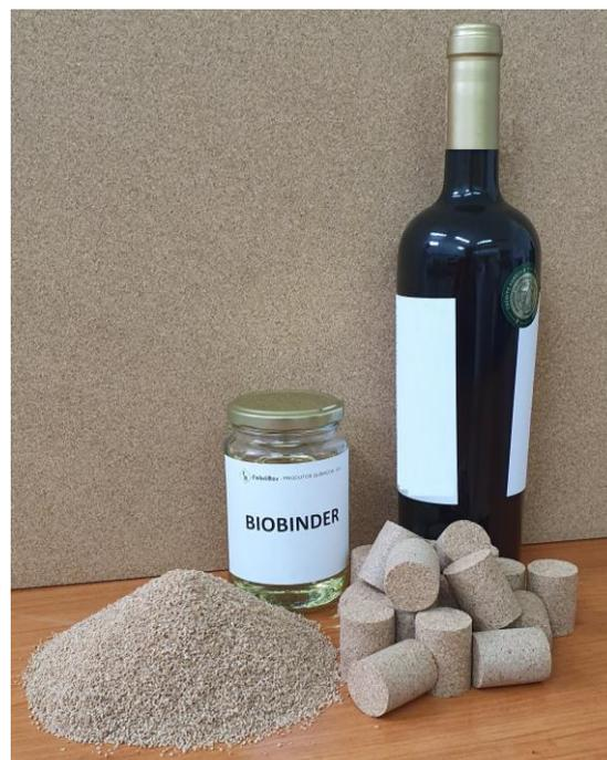
Figura 6 – Exemplos de aplicação da cola ligante para cortiça.
