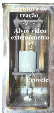
Figura 3. Proвете no interior da câmara térmica
